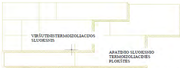
Termoizoliacinių plokščių slinktis klojant viršutinį ir apatinį sluoksnius.
