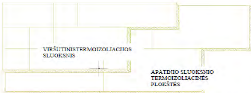
Termoizoliacinių plokščių slinktis klojant viršutinį ir apatinį sluoksnius.
