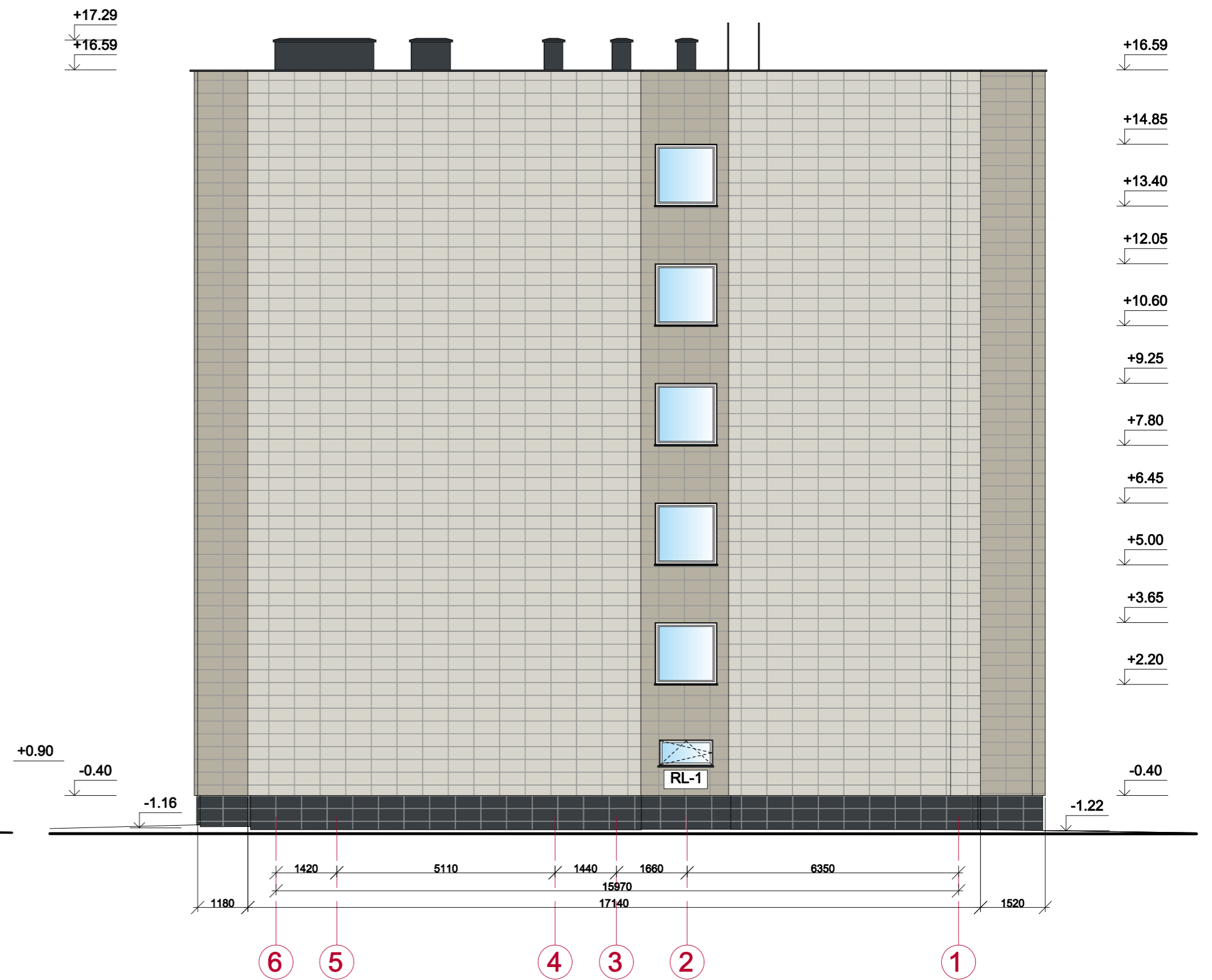
FASADAS TARP AŠIŲ 6-1 M 1:100
